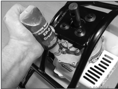
Рис. 15 Добавление смазки в корпус редуктора
