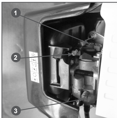
Рис. 14 Расположение винтов регулировки карбюратора.
